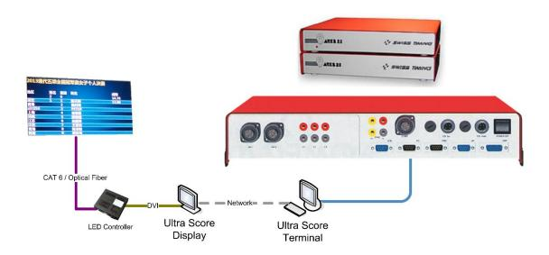
体育比赛计时记分系统能够控制欧米茄 ARES21 系统的计时与记分功能。 只需将欧米茄 ARES21 设备的 PC 端口连接至比赛计时记分系统的 PC 端口即可。
